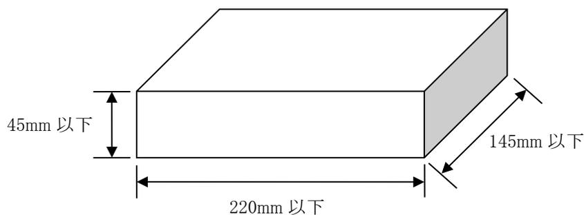
図 1-1 回線終端装置の形状および寸法
