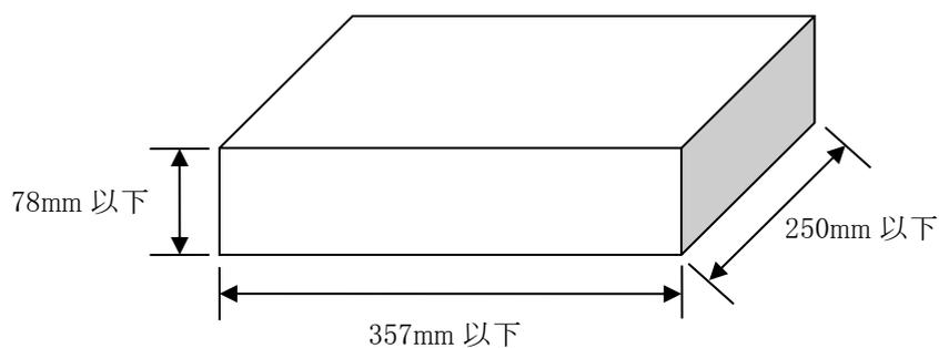
図 2-1 回線終端装置の形状および寸法
