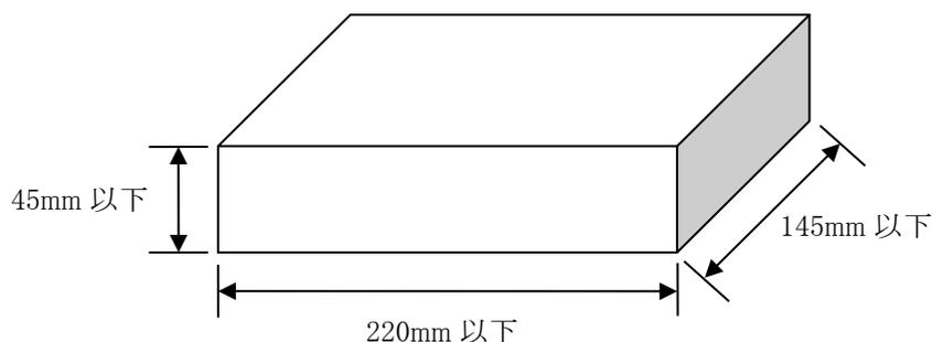
図 3-1 回線終端装置の形状および寸法
