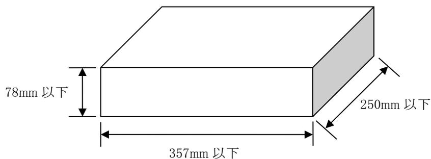
図 4-1 回線終端装置の形状および寸法
