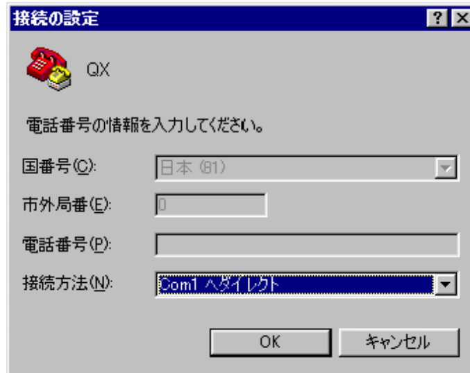
図 2-3 HyperTerminal 接続で使用されるシリアルポートの設定
