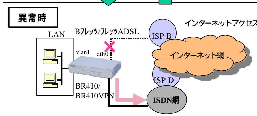
ルータが回線異常と判断した場合に別ルート（この場合はISDN網）経由で接続する。（回線異常と判断させるために任意のIPアドレスに定期的にPingをうち、その反応によって状況判断して自動的にルートを変更します。正常に復旧した場合は、自動的に正常ルートへ戻ります）
