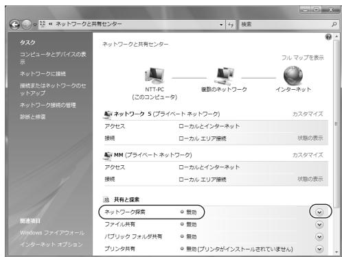
**3 [ネットワーク探索を有効にする] をクリックし、[適用] ボタンをクリックします。**
