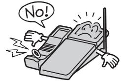
●万一、本商品の内部に水などの液体が入った場合、すぐに本商品から電話機コードまたはLANケーブルをそれぞれ電話機コード差込口またはLANポートから抜き、電池パックを外して、当社のサービス取扱所にご連絡ください。そのまま使用すると、火災・感電の原因となることがあります。
