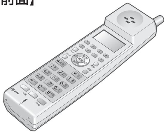
※1 ダイヤルボタン [5] と音量調節ボタンの大的部分に突起が付いていますが、この突起は目のご不自由な方の操作を容易にするためのものです。
