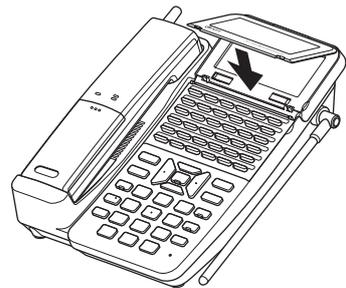
**2** 交換する電話機 LCD パネルの上部分を着信ランプの溝に差し込みます。
