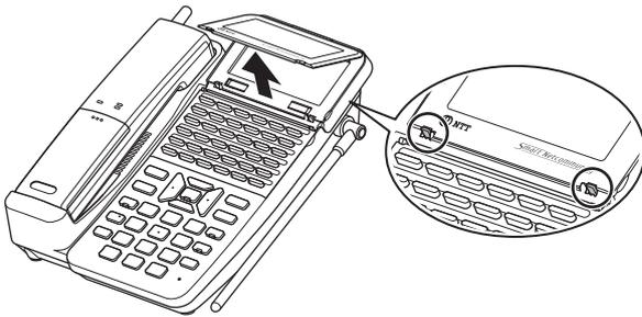
**3** 電話機 LCD パネル下の2か所のツメを電話機に差し込みます。
