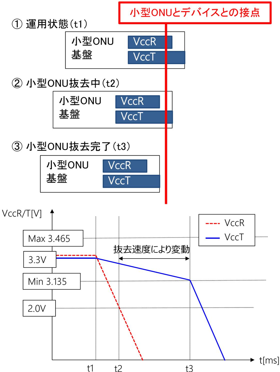
図1.4 【参考】小型ONU抜去時の電源挙動イメージ
