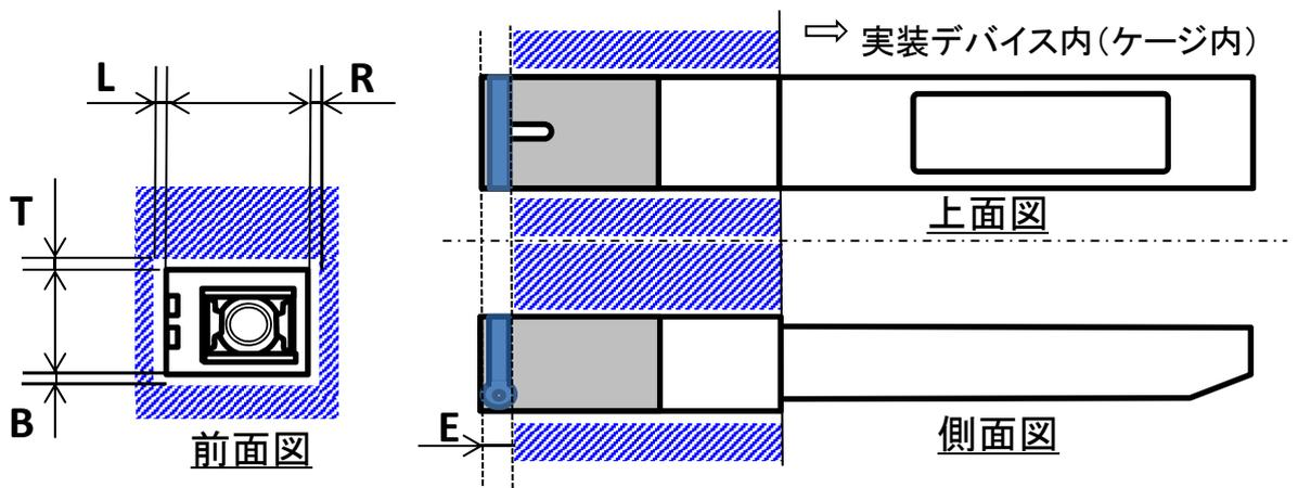
図2.2 実装デバイス端面から小型ONU端面を突出させる場合の離隔イメージ
