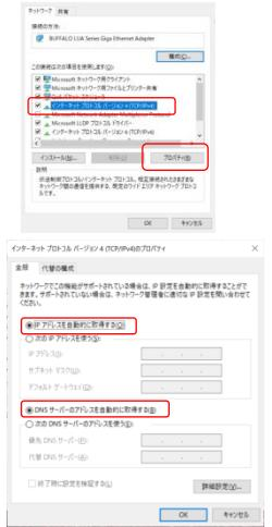
次にギガらくVPN装置をインターネットに接続する設定をします。(PPPoE設定)
