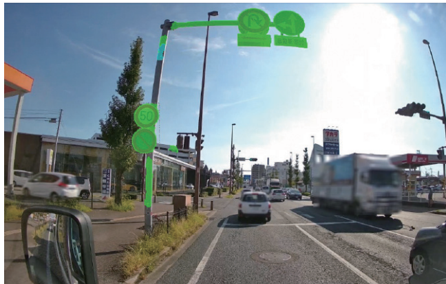
ドライブレコーダーの映像データをAI解析することで、標識やミラーの損傷を効率的に発見できる
