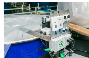
酒蔵に設置されたIoTカメラ、IoTセンサー
